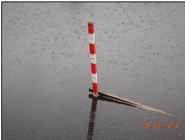
Fotografía 1. Coordenadas UTM DATUM WGS84 18S Descripción del medio de prueba: Regleta que marca aproximadamente 1,76 metros del nivel del espejo de lixiviados, siendo posible registrar por su graduación, hasta un máximo de 2,50 metros.
